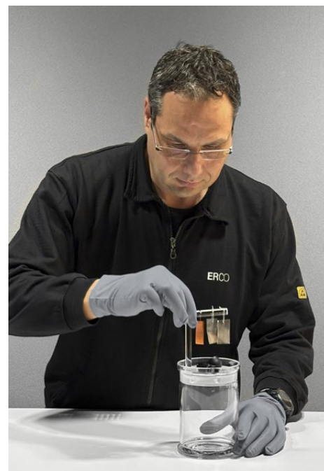
Prueba Oddy con luminarias para vitrinas Axis
